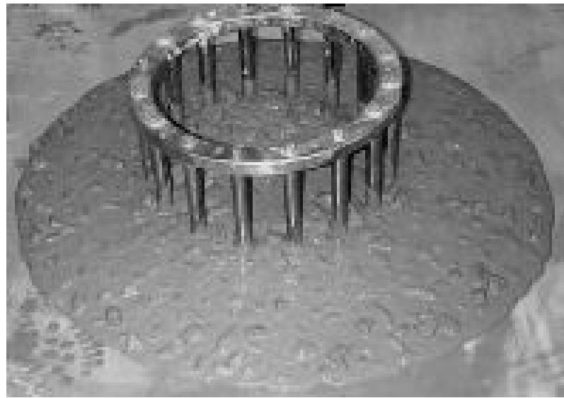
شکل ۳- جریان بتن بعد از بلند کردن قالب
