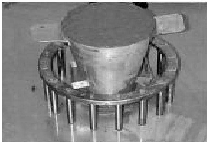
شکل ۲- قراردادن معکوس قالب پر شده از بتن خود تراکم
