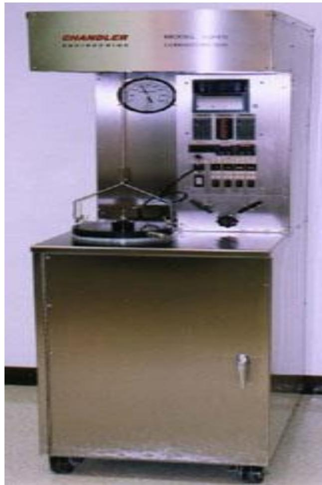
IMAGE ۵: HIGH PRESSURE HIGH TEMPERATURE THICKENING TIME
