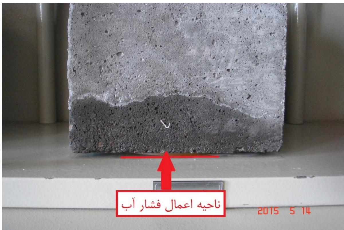
شکل الف-۳- نمونه ای از آزمونه تحت فشار آب
