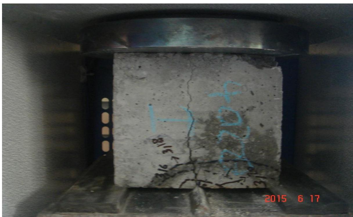
شکل الف-۴- نمونه آزمونه در وضعیت دو نیم شده
