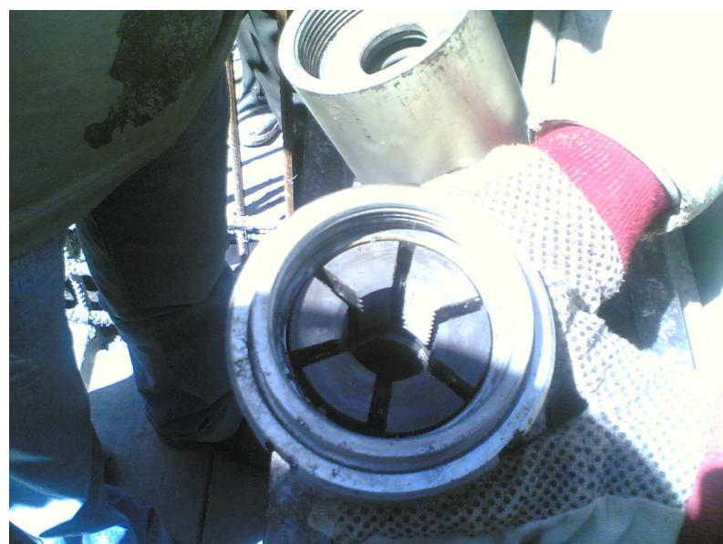
نمای داخل یک جک دندانه ای
